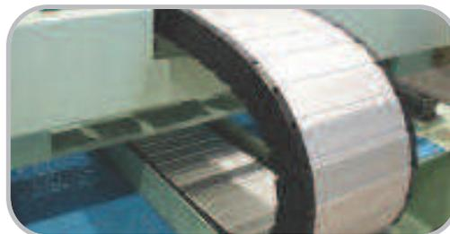
I nuovi traversini in alluminio anodizzato completano l'offerta di catene di tipo completamente chiuso nsb045AE-060AE-075AE. Permettono di realizzare anche catene a misura. Sono consigliati nei casi in cui si debba proteggere completamente i cavi da contaminazioni esterne di vario tipo. Inoltre hanno un gradevole impatto estetico.
