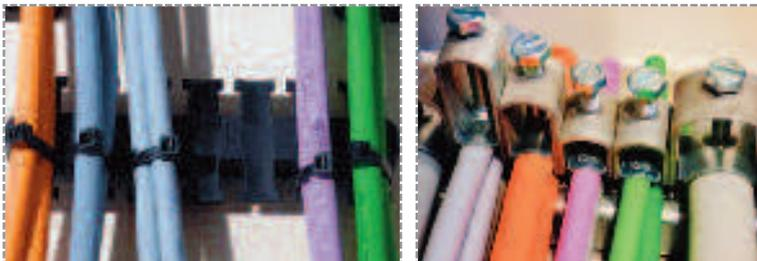
I fissacavi possono essere in nylon o in acciaio. Vanno montati fuori dall'attacco sia sul punto fisso che nel punto mobile.
