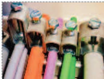
I fissacavi possono essere in nylon o in acciaio. Vanno montati fuori dall'attacco sia sul punto fisso che nel punto mobile.
