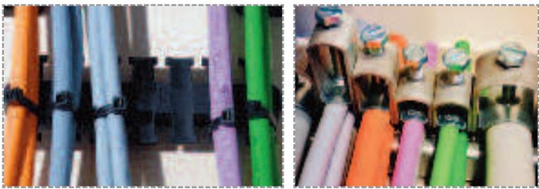
I fissacavi possono essere in nylon o in acciaio. Vanno montati fuori dall'attacco sia sul punto fisso che nel punto mobile. Sono consigliati in nylon quando si devono bloccare cavi o tubi di diametro piccolo (max 18mm) altrimenti sono da utilizzare i fissacavi in acciaio. Se non utilizzati i cavi e i tubi possono migrare dalla loro posizione e a causa della trazione/spinta che viene generata dal moto della catena cambiare di posizione e danneggiarsi.
